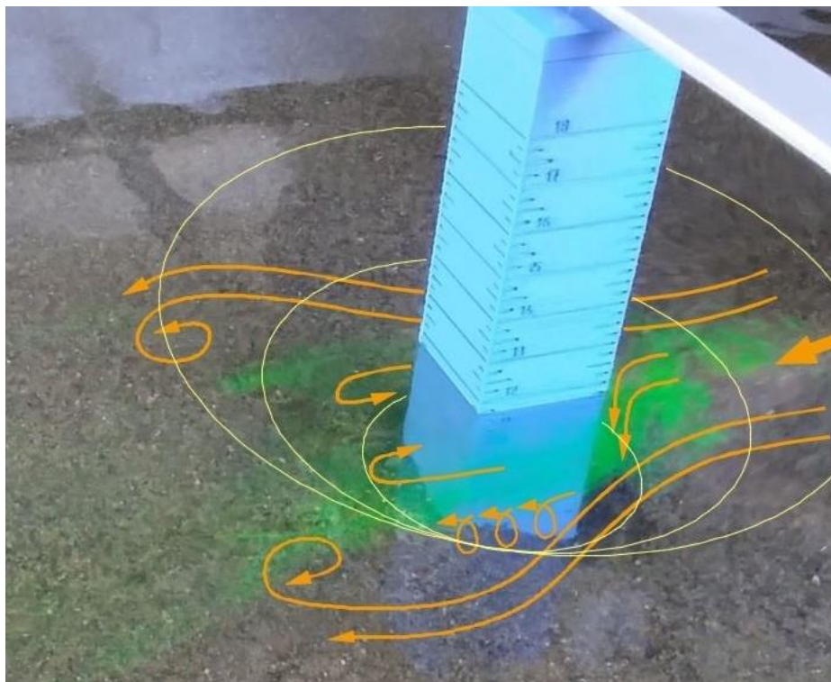
Fig. 5. Esquema de sistema de vórtices alrededor de la pila y visualización con fluoresceína.
