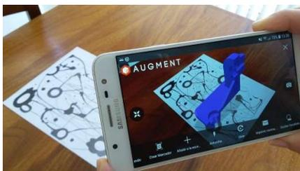
**Fig. 6.** Visualización del modelo sobre el rastreador empleando el teléfono móvil.
