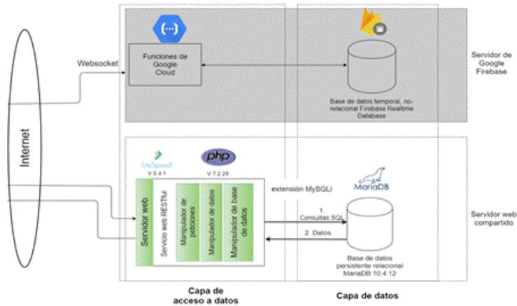
**Fig. 2.** Arquitectura de los componentes de acceso a datos y envío de mensajes de SignChat.
